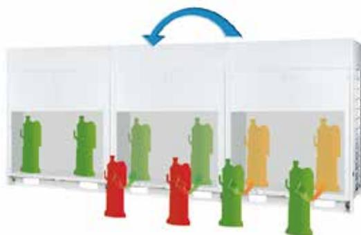
Errore Slave 1, l'unità non funziona, entra in stato di standby, gli altri moduli possono ancora funzionare.
